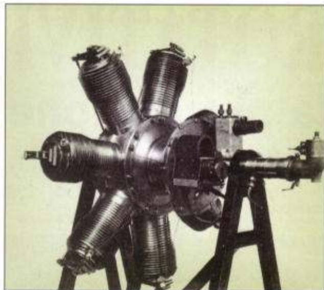
A sinistra: vista posteriore di uno Gnome Omega da 50 CV; si notino il magnete e la pompa dell'olio ai due lati dell'albero ed il carburatore alla sua estremità. Sotto: disegno in sezione, d'epoca dello stesso tipo di motore.
