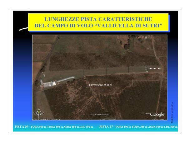
In pratica è dimostrato che con i velivoli avanzati di oggi, con un peso massimo al decollo di 450 kg (ma spesso molto di più) occorre una ASDA non inferiore a 450/500 metri.
